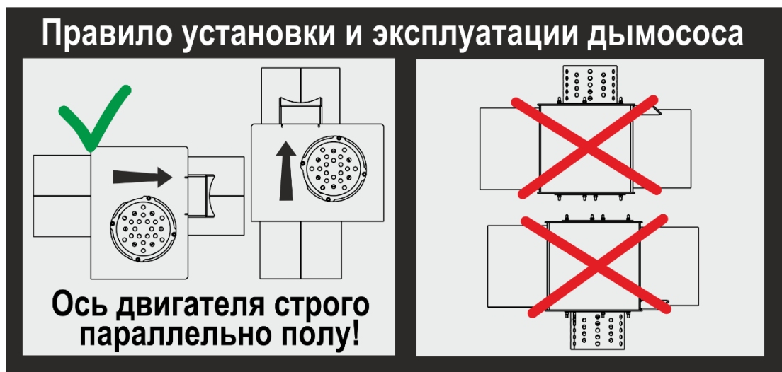
Рис. 1 Установка дымососа
